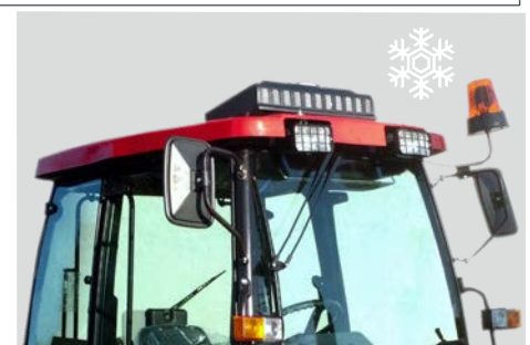
Установка кондиционера Installation of air conditioner
