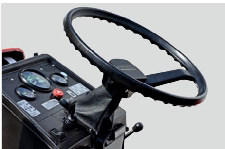
Гидроусилитель руля для облегчения управления Power steering for easier control
